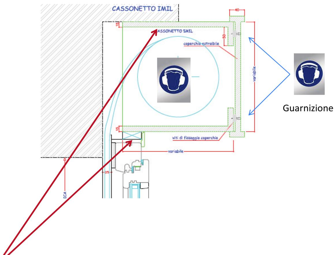
Fissaggio meccanico Tramite viteria idonea sulla traversa superiore telaio
